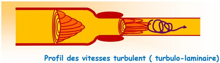
Profil des vitesses turbulent ( turbulo-laminaire)
